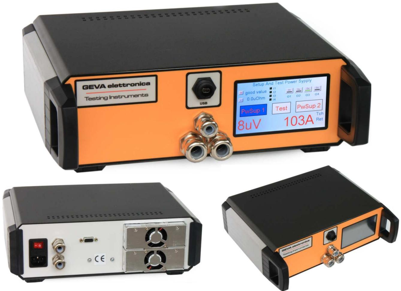
Preciso strumento di misurazione di micro Ohm, collaudo di saldature, contatti, ecc.
